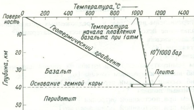
Рис. 4-3. Модель генерации магмы по Йодеру [488], основанная на снятии напряжения при растяжении.
