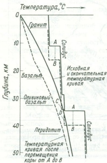
Рис. 4-6. Модель генерации магмы при погружении по Хессу [178].
