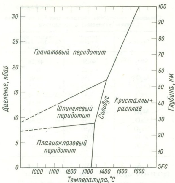
Рис. 2-10. Обобщенная фазовая диаграмма для различных перидотитов, построенная по экспериментальным данным, представленным на рис. 2-8.
