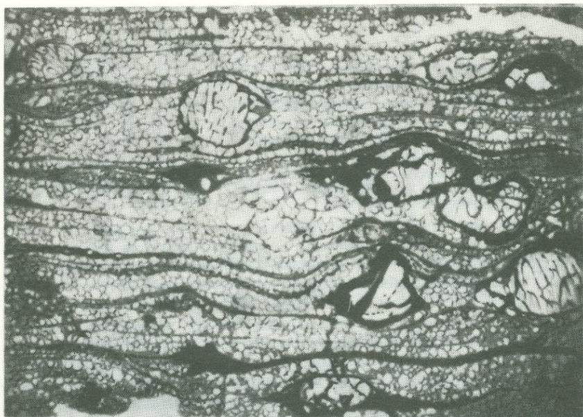
Рис. 9-6. Гранатовый перидотит, претерпевший сдвиговые деформации. Образец № 1611. Таба-Путсоа, Лесото. Ширина шлифа примерно 12 мм. Фотография любезно предоставлена д-ром Бойдом.
