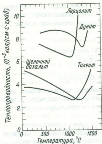
Рис. 4-9. Изменение теплопроводности лерцолита, дунита [213] и двух типов базальтов [296] в зависимости от температуры.
