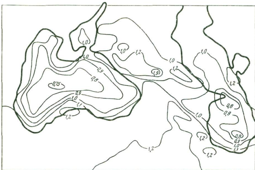
Рис. 2. Расчетная карта теплового потока, кал/см 2 · с
