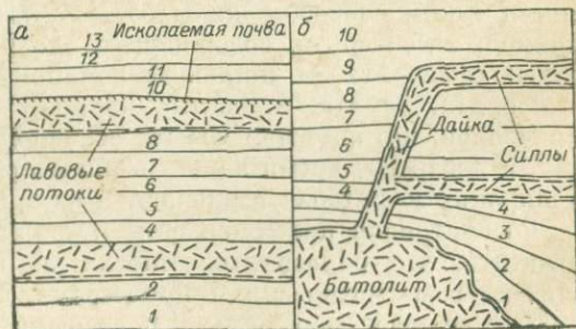
Рис. 100. Возрастные взаимоотношения эффузивных (а) и интрузивных (б) пород и вмещающих их отложений.
