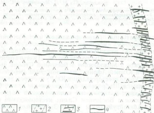
Рис. 65. Дайка гранит-порфиров в плане с пересекающими ее лестничными жилами. Березовское золоторудное месторождение. По Н. И. и М. Б. Бородаевским.
