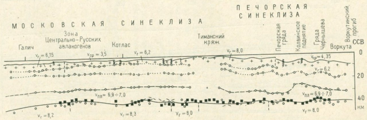
Рис. 18. Сейсмический разрез земной коры Черное море — Карское море: 1 — поверхность фундамента; 2 — поверхность М; 3 — глубины до поверхности М по данным преломленных волн; 4 — отражающие площадки; 5 — глубины, определенные по обменным волнам; 6 — зоны нарушений; 7 — контакты пород с различной скоростью распространения волн
