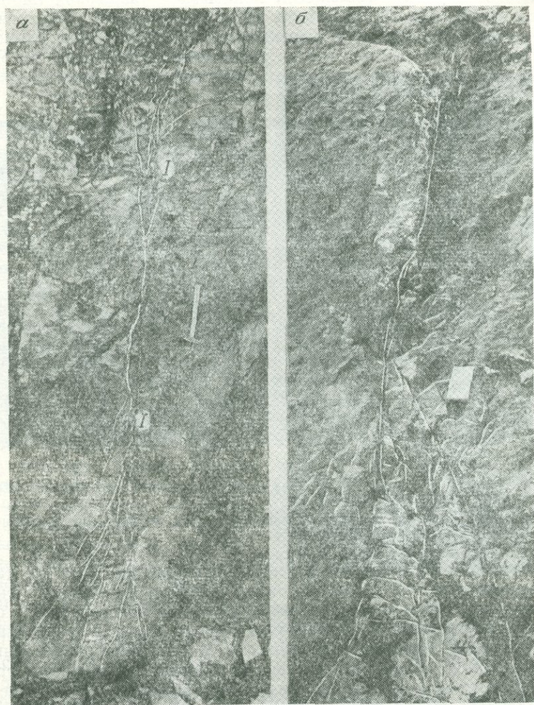
Рис. 22. Обнаженные мелкие разрывы с вторичными сколами, приуроченными к их окончаниям:
