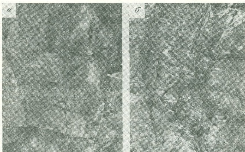
Рис. 40. Зоны скалывания с поперечными ( A_1 ) трещинами: a — кварцевый порфир (см. рис. 16, 8); б — пиринский гранит (см. рис. 16, 4)
