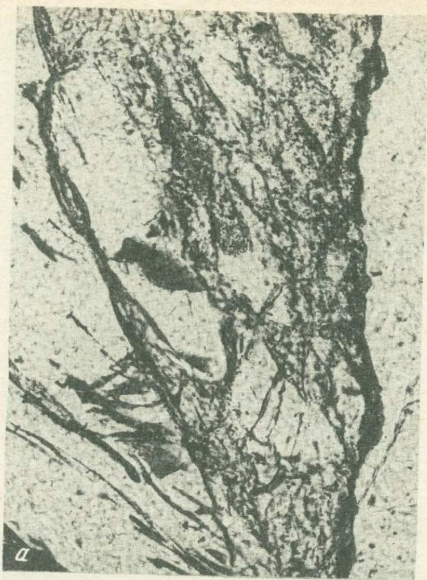
Фиг. 2. Распределение включений в черном непрозрачном обсидиане. Николь один;
