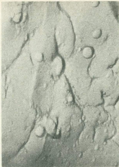
Фиг. 5. Черное прозрачное стекло. Реплика. Увел. 1400, травление 25 с, 35% HF
