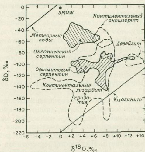
Рис. 40. Вариации отношений стабильных изотопов водорода и кислорода (диаграмма \delta D-\delta^{18}O ) в серпентинитах разного происхождения [417, 419]. L—C — lizardit—хризотил. Отметим, что океанические серпентиниты четко отличаются от континентальных серпентинитов и серпентинитов офиолитов.
