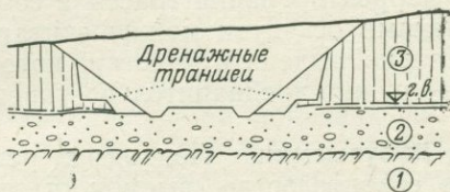
Рис. 6.3. Глубокая выемка, вскрывшая обводненные гравелистые аллювиальные отложения.
