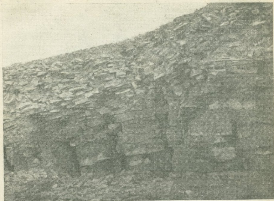
Рис. 3.4. Разрушение песчаных мергелей мелового возраста в перигляциальных районах (карьер Предни Копанина в окрестностях Праги, высота забоя 6 м) (фото Зарубы).
