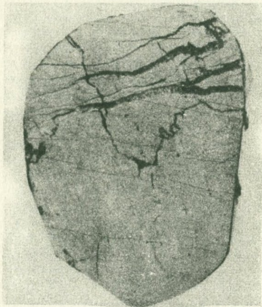
Фиг. 18. Кремнистый известняк с жилками кальцита и гематита. Пришлифовка. Увел. 2, 4.
