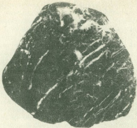
Фиг. 12. Красно-бурая яшма, рассеченная прожилками кальцита и кварца. Пришлифовка. Увел. 2,3
