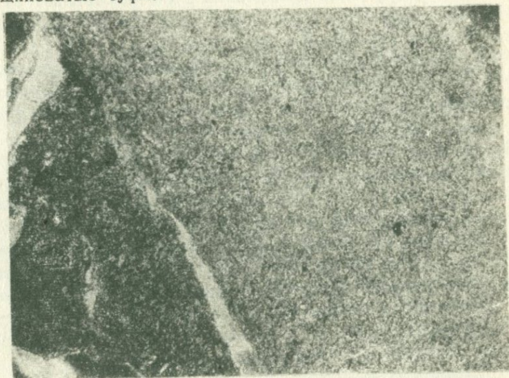
Фиг. 7. Пелитовый аповитрический туф. Шлиф. Увел. 72, ник. 1
