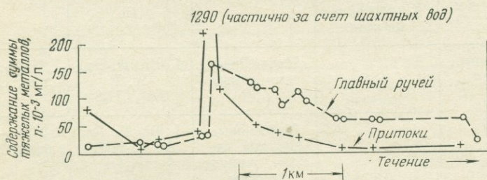
Рис. 77. Содержание суммы тяжелых металлов в водах ручья. По Е. А. Сергееву
