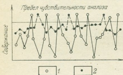
Рис. 17. Влияние предела чувствительности анализа на процент обнаружения элемента.
