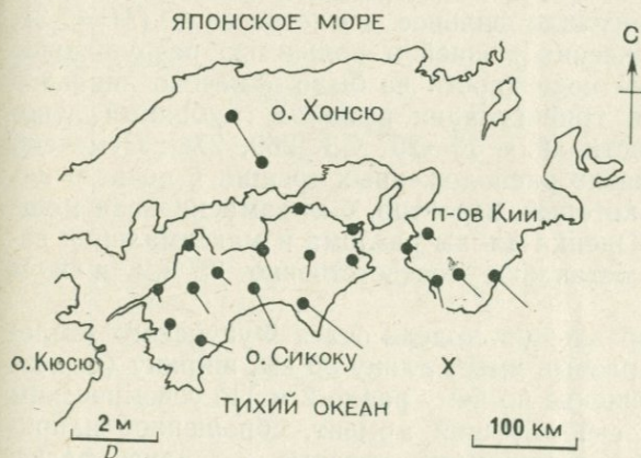
Рис. 5.14. Горизонтальные смещения пунктов триангуляции I класса при Нанкайском землетрясении 1946 г. Отрезок прямой, соединяющий две станции на о. Хонсю, представляет собой базис, который, как предполагают, не был затронут землетрясением. Крестиком указан эпицентр [98, 99].
