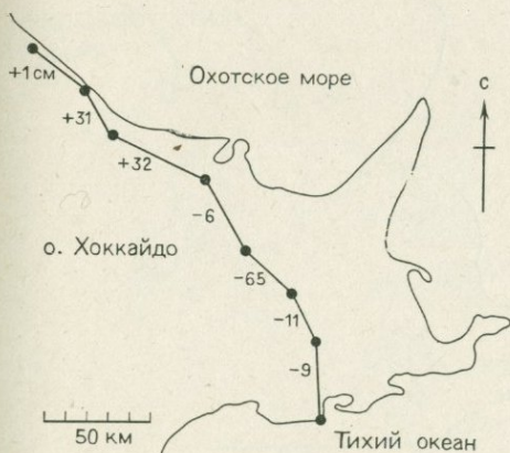
Рис. 5.35. Изменение расстояний (в см) между соседними пунктами триангуляции по профилю на востоке Хоккайдо за период 1907—1972 гг. [106].
