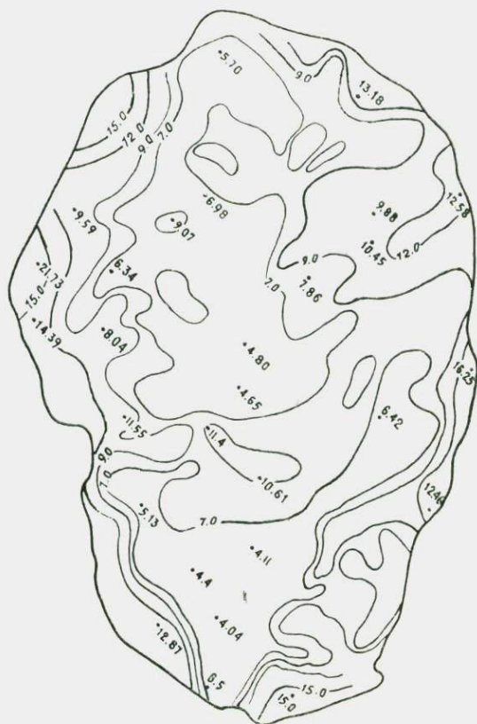
Р и с. 4. Распределение содержания MgO (в %) в кимберлитовых породах верхних горизонтов трубки Мир
