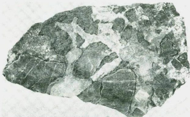
Рис. 2. Эксплозивные брекчии фронтальной зоны Хараелахской ветви Талпахского месторождения (в обломках — витродолериты, цемент — рудный+кальцифиры; рудник Комсомольский, штуп, уменьш. в 2 раза)
