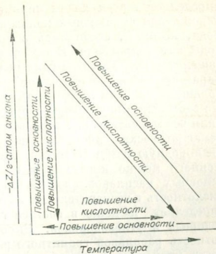
Рис. 42. Изменения кислотно-основных свойств соединений в координатах \Delta Z - T^\circ\text{C} .
