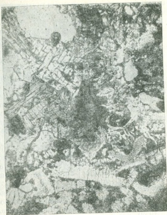
Рис. 6. Скопления геленита (мелилита) в прикон- тактовой зоне. P = 1500 атм N_2 , T = 1150^\circ C , пиколи скрещены. \times 60 .
