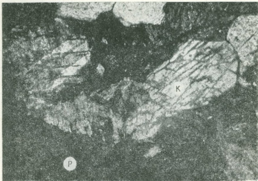
Рис. 3. Характер взаимодействия гранитного расплава (P) с кальцитом (K) при P = 3500 атм \text{CO}_2 .
