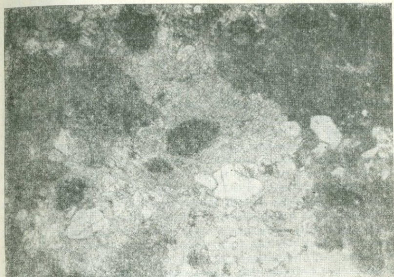
Рис. 8. Кристаллы форстерита в доломите. P = 3100 атм \text{CO}_2 , T = 1000^\circ\text{C} , николи скрещены. \times 75 .
