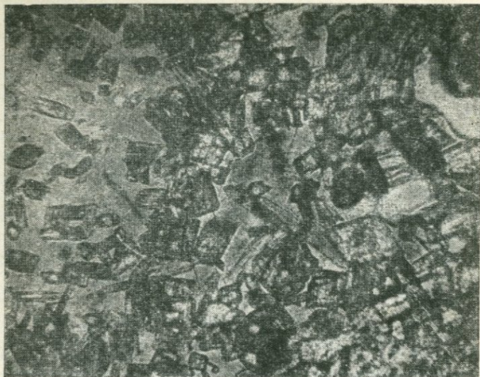
Рис. 16. Кристаллы фассаита на контакте расплава с доломитом. T = 900^{\circ}\text{C} , P = 2300 атм \text{CO}_2 + \text{H}_2\text{O} , без анализатора. \times 60 .
