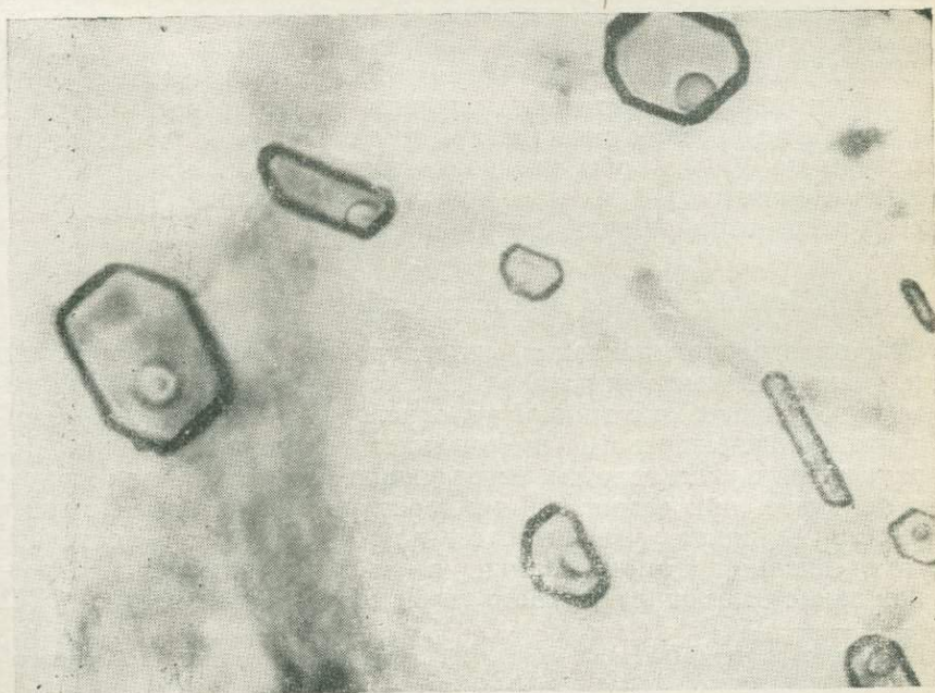
Фиг. 7. Двухфазовые включения «чистой» углекислоты при 9^{\circ}\text{C}
