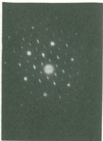
Фиг. 4. Микродифракционная картина антигорита (обр. 1). Четко виден сверхпериод по оси a
