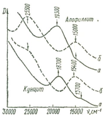
Рис. 73. Спектры поглощения розового апофиллита и кунцита с природной окраской (а) и облученных, окрашенных в зеленый цвет (б).
