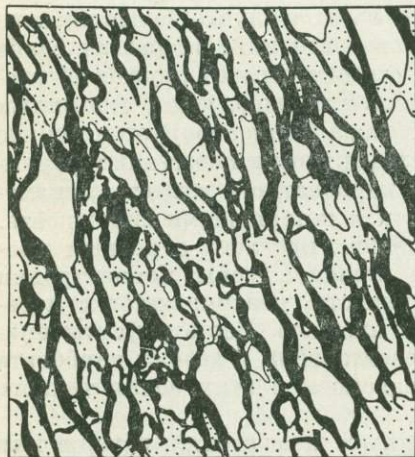
Рис. IV-1. Приуроченность поверхностей кливажа к границам зерен в глинистом песчанике с базальным цементом (рисунок по микрофотографии). По Н. Б. Лебедевой (1972).
