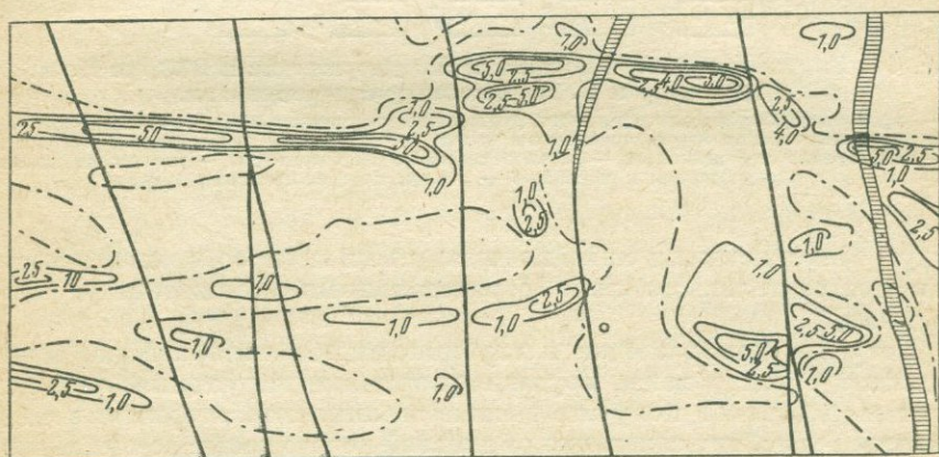
Рис. 9. Выявление разломов по изменению корреляции аномалий \Delta Z
