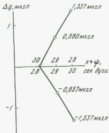
Рис. 7. Амплитуды искажений в показаниях гравиметра за наклоны в 2 сек дуги в вертикальных плоскостях, проходящих через маятник и его оси вращения
