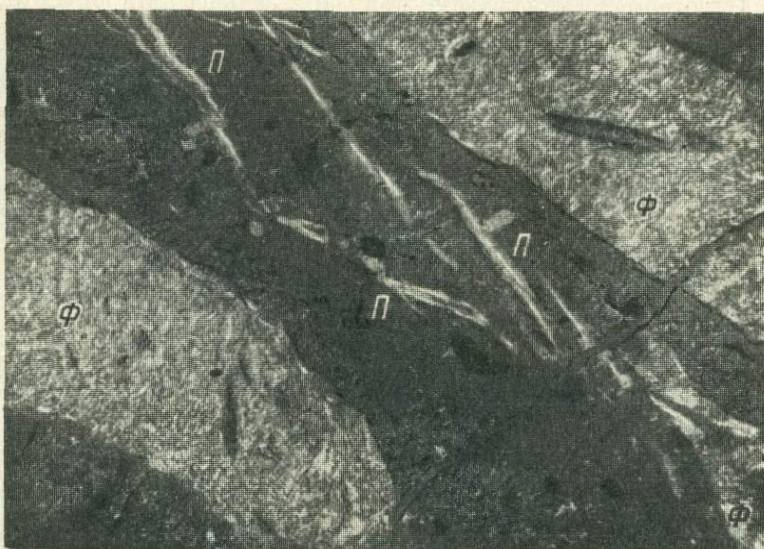
Рис. 4. Пентагидроборит (П) в измененном курчатовите вблизи флюоритовых прожилков (Ф). Николи скрещены, увел. 72.
