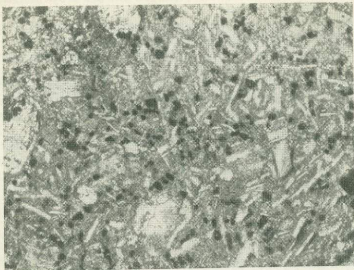
Рис. 1. Равномерное распределение микрокристаллического ильменита (черное) в кимберлите с порфировой структурой связующей массы и микролитовой структурой основной массы. Без анализатора. Увел. 25. Трубка «Круглая».
