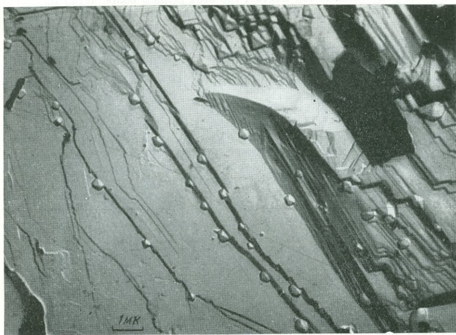
Фиг. 5. Реплика со скла сфалерита того же месторождения. Видна строгая приуроченность микровключений к направлениям спайности
