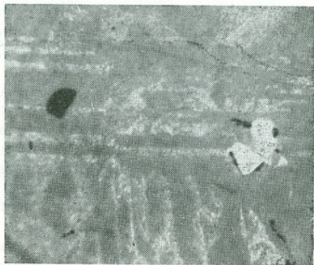
Фиг. 12. Участки пылевидного станнина (светло-серое) в двойникованном сфалерите (темное). Белые зерна — пирит. Благодатское месторождение. Полир. шлиф. Увел. 670
