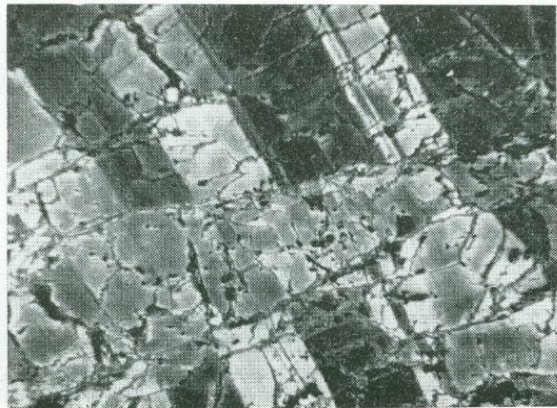
Фиг. 9. Крупнозернистый сдвойникованный катаклазированный сфалерит, по трещинкам — кальцит. Северо-Акатуевское месторождение. Протравлено. Полир. шлиф. Увел. 90
