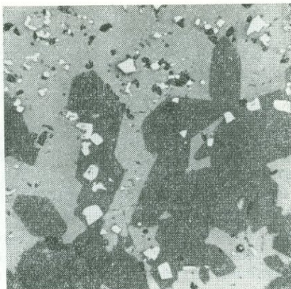
Фиг. 10. Метакристаллы пирита (белое) и кварца (черное) в агрегатах сфалерита (серое). Екатерино-Благодатское месторождение. Полир. шлиф. Увел. 40
