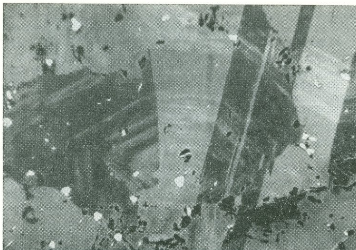
Фиг. 16. Зональное и двойниковое строение зерна сфалерита (серое разных оттенков). Белое — мелкие зерна пирита. Благодатское месторождение. Протравлено. Полир. шлиф. Увел. 90
