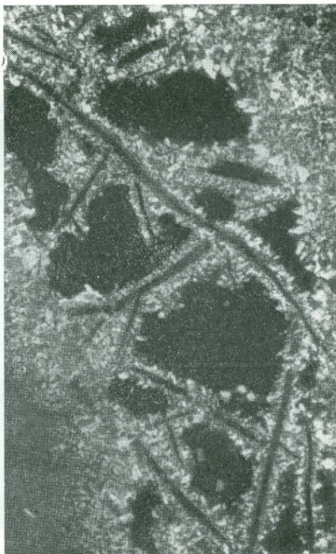
Фиг. 13. Пористый каркас из тонких пластинок золота (темное), обросших гребенчатым кварцем (светлый). Черное — пустоты. Прозрачн. шлиф. Ник. +. Увел. 10
