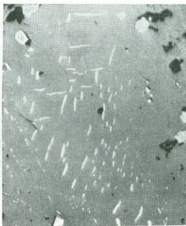
Фиг. 11. Зерна пирита (белое), пластинки халькопирита и пылевидные частицы станнина (светло-серое) в массе сфалерита. Черное — пустоты. Благодатское месторождение. Полир. шлиф. Увел. 320
