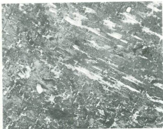
Р и с. 6. Микроструктура пертитового полевого шпата из эндоконтактового рихсчоррита. Реликт микропертита (справа вверху) в криптопертите со следами переотложения альбитовой фазы
