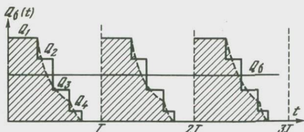
Рис. 3. Аппроксимация действительной кривой изменения инфильтрационного расхода грунтовых вод из бассейна ступенчатой функцией
