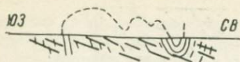
Рис. 22. Один из разрезов через северо-западную часть хребта Пае, п-ов Камни. Пологие сланцеватость и кливаж наложены на складчатую структуру. По А. А. Предовскому (1971).
