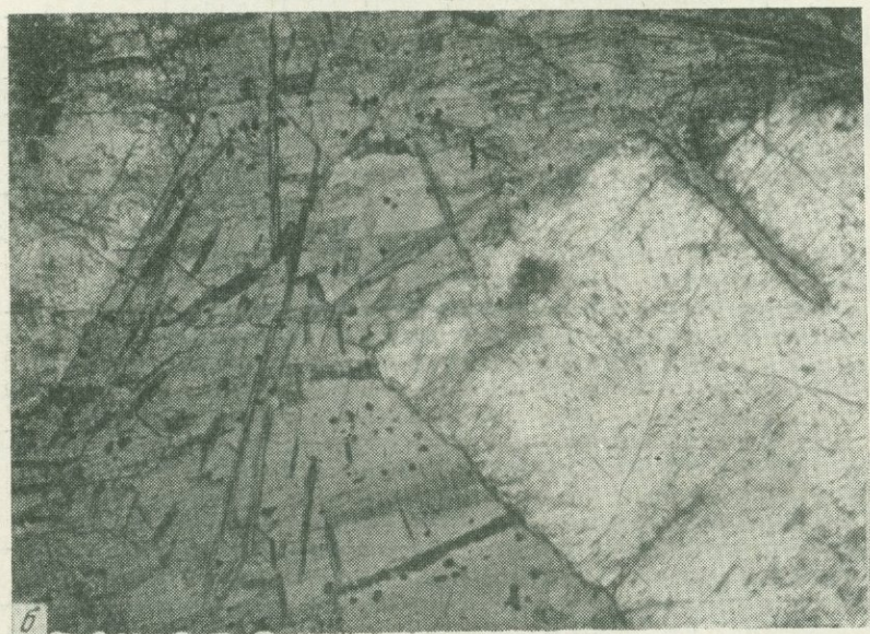
Фиг. 1. Формы выделения ломоносовита и мурманита из месторождения Кукисвумчорр, увел. 30; без анализатора
