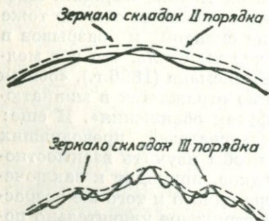
Рис. 14. Схематическое изображение асимметричных складок второго и третьего порядков на крыльях крупной антиклинали. С уменьшением размеров складок увеличивается их сжатость, а зеркало складчатости становится все более криволинейным.
