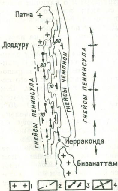
Рис. 10. Принципиальная схема расположения асимметричных складок второго и третьего порядков в рудном поле Колар. Составил Ю. И. Казанин по материалам С. Нарайянасвами и др. (1964). 1 — граниты; 2 — разрывы; 3 — направления погружения складок и залегание пород; 4 — ундуляция оси главной антиклинали.
