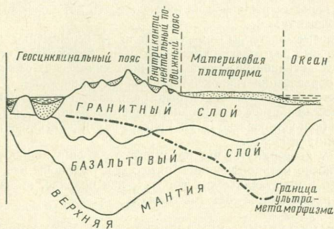
Рис. 58. Основные типы строения земной коры (по В. Е. Ханину, 1964) и схематическое положение верхней границы ультраметаморфизма
