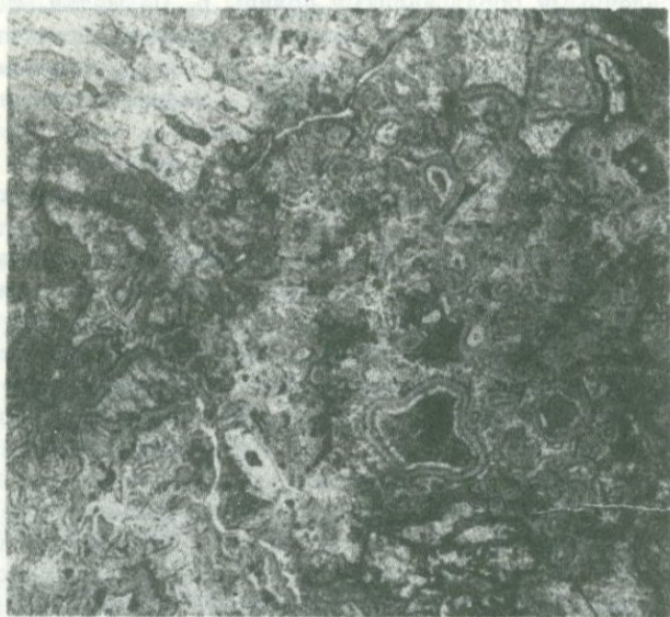
Рис. 2. Замещение цементирующей стекловатой массы и поровых пространств псефитовых туфов дацита: в центре пор - халцедон, по периферии - кальцит (иногда ломонит) и глинистый минерал (обр. 6549, скв. К-8, глубина 79 м). Николи скрещены, увел. 320
