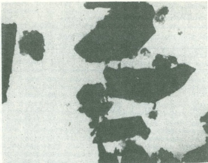
Рис. 26. Мелкотаблитчатые кристаллы новообразованного ломонитита. Эксперимент с пемзой. Электронная микроскопия (суспензированный препарат). Увел. 11400
