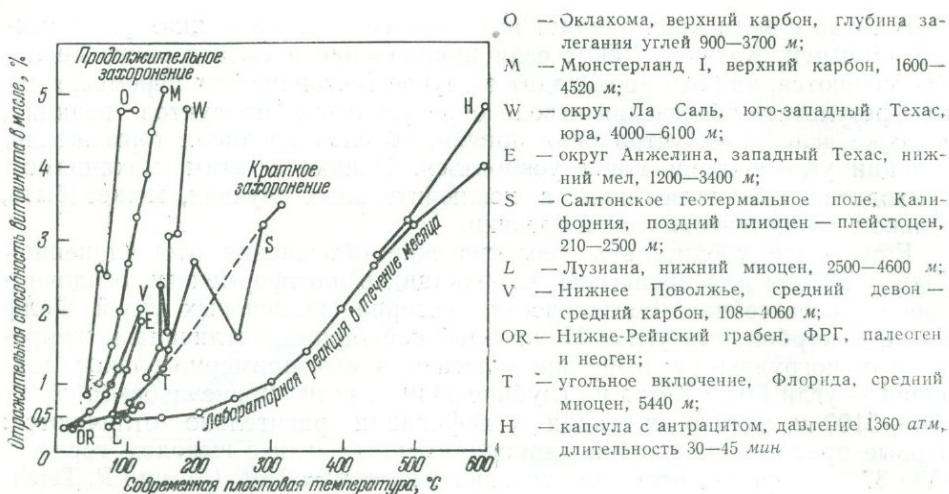
Фиг. 2. Компенсирование геологического времени температурой при углефикации (Bostick, 1971)
