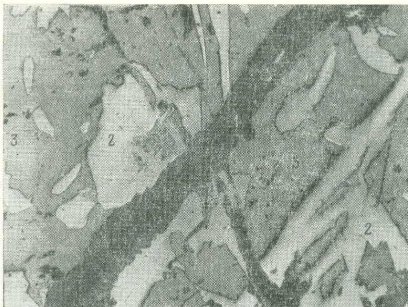
Рис. 33. Карбонатный прожилок (1) с мелкоигльчатым буланжеритом (анализ 2 в табл. 3), секущий менегинит (2, анализ 1 в табл. 3); основная масса сфалерит (3). Северный Акатуй. Полированный шлиф. Увел. 50
