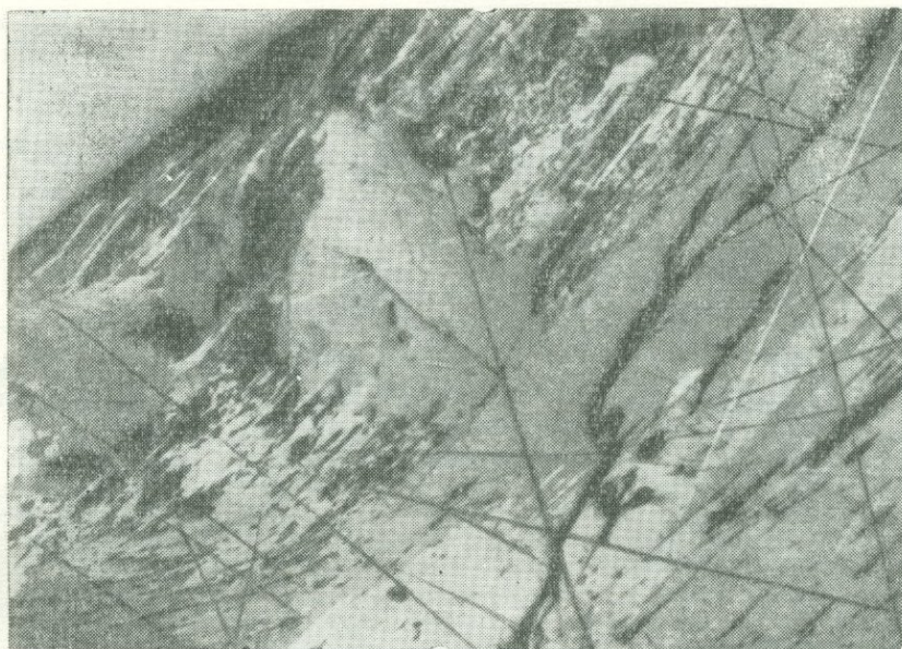
Рис. 32. Мелкоигльчатый буланжерит, образовавшийся после джемсонита (основная масса). Месторождение Центральное. Полированный шлиф. Николи+. Увел. 100
