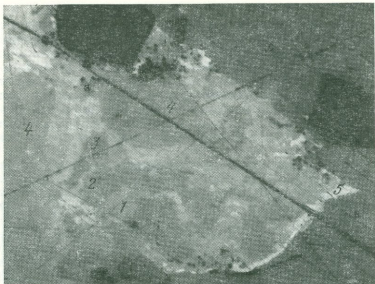
Рис. 41. Графическое срастание 1 — \text{Pd}_3\text{Pb} и 2 — \text{Pd}(\text{Pb}, \text{Bi}) ; 3 — включения плюмбопалладинита \text{Pd}_3\text{Pb}_2 ; 4 — (\text{Pd}, \text{Cu})_3(\text{Sn}, \text{Cu}) ; 5 — сплав (\text{Ag}, \text{Au}) , темно-серое — галенит в халькопирите. Талнахское м-ние. Ув. 340
