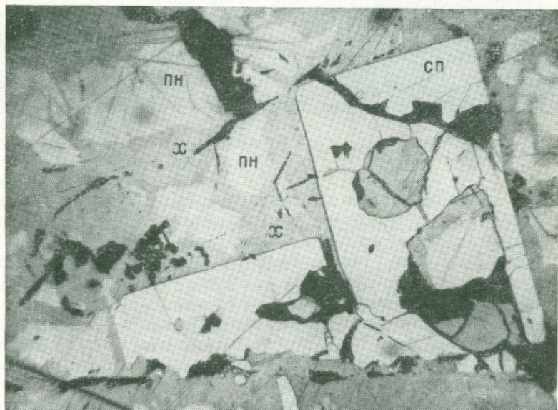
Рис. 42. Метакристаллы сперриллита (сп) в халькопирите (х) и пентландите (пн). Талнахское м-ние. Ув. 340
