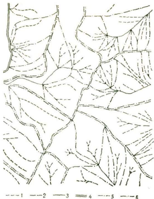
Рис. 3. Схема порядков водораздельных линий, по зависимой системе: Долины: 1 — 1-го порядка; 2 — 2-го порядка; 3 — 3-го порядка; 4 — 4-го порядка. Водораздельные линии: 5 — 2-го порядка; 6 — 3-го и более высоких порядков
