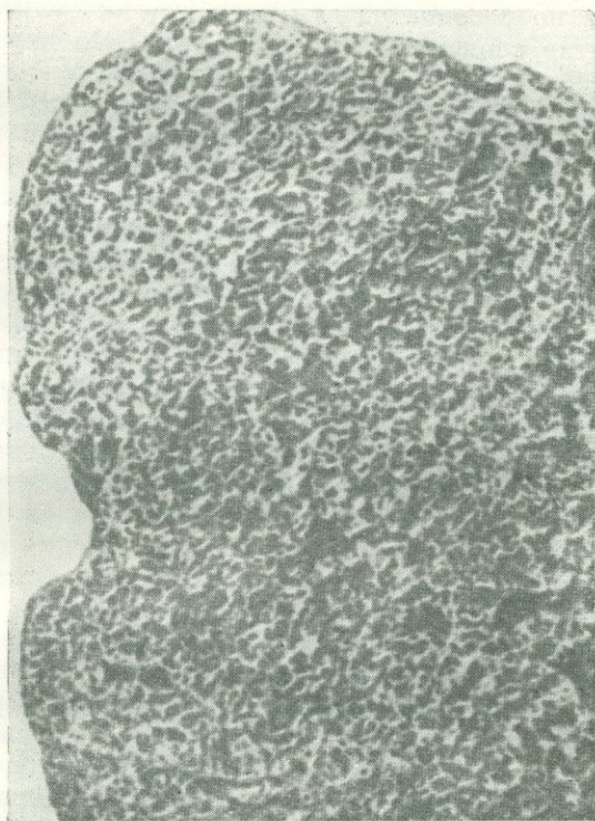
Фиг. 11. Губковая текстура лимонита, образовавшегося при окислении сплошного сфалерита. Месторождение Эмпайр Цинк Майн, Новая Мексика. \times 1.2 . Фот. Блэнчарда и Босуэлла.
