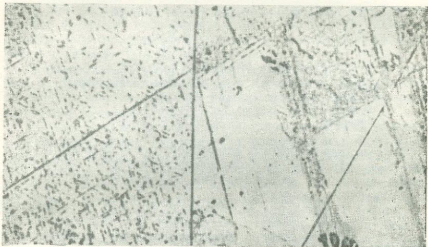
Фиг. 19. Характер развития англезита в галените. Мальцевско-Килгинское месторождение, восточное Забайкалье. Фот. Л. В. Радугиной.
