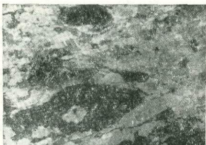
Рис. 26. Порфировидная структура галито-карналлитовой породы (черное — галит; светло-серое — карналлит). Шлиф, ник. +, \times 6 (Карлюкское месторождение)
