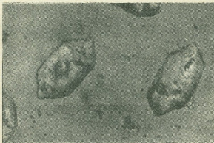
Рис. 9. Тонкий шлиф, показывающий типичные аутогенетические кристаллы кварца в известняке ( \times 160 ).
