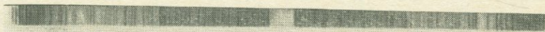
Рис. 78. Порошковая дифракционная модель виллемита ( Zn_2SiO_4 ), полученная с излучением K_{\alpha} -линии кобальта на пленке, закрепленной по Ван Аркелю.
