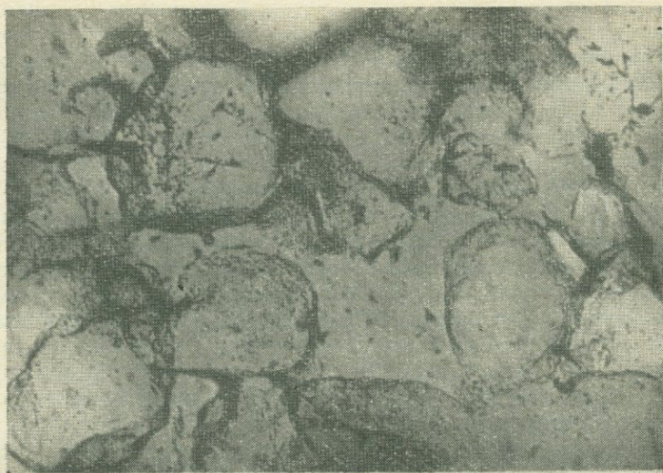
Рис. 10. Тонкий шлиф искусственного кварцита, образованный цементацией кварцевого песка с аденозинтрифосфатом ( \times 160 ).
