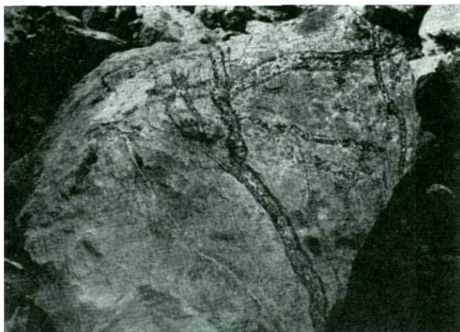
иг. 31. Зональные апатит-магнетитовые прожилки в мелкозернистых орстеритовых породах, Ковдор. Уменьшено в 4,5 раза
