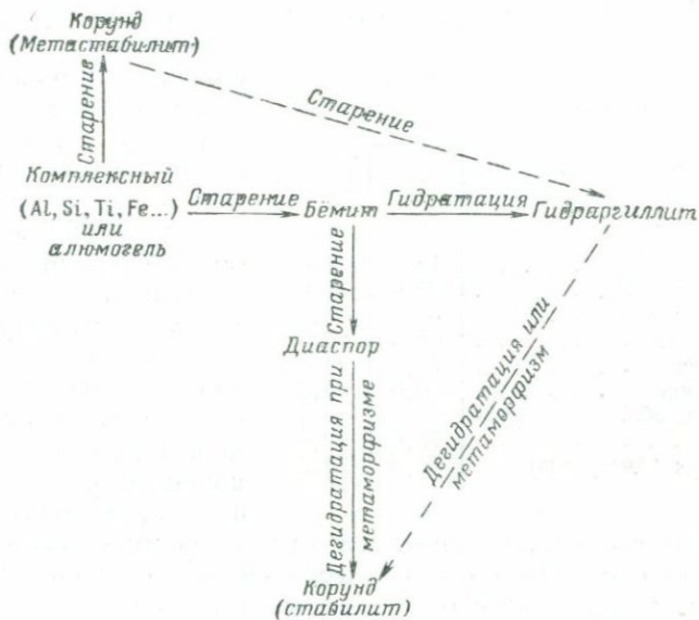
Рис. 41. Схема минералобразования в бокситах
