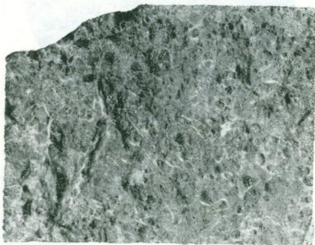
Рис. 13. Развитие каолинита по микротрещинам в боксите
