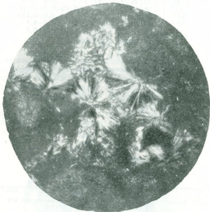
Рис. 17. Радиально-волокнистые агрегаты хлорита в бокситах Кайракского месторождения УзССР. \times 40
