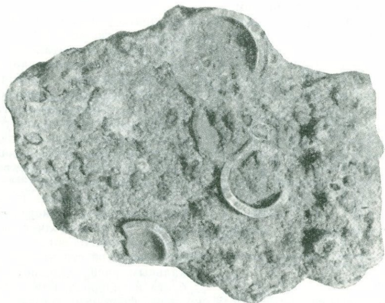
Рис. 25. Сферолиты, сложенные сидеритом, концентрического и радиально-лучистого строения. Нат. вел.
