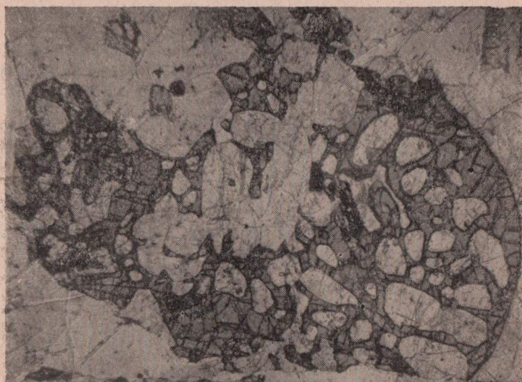
Фиг. 6. Пойкилобластический кристалл везувиана (серое) с включениями многочисленных более мелких кристаллов альбита (белое). Прозр. шлиф, без анализатора, увел. 48. Улан-Эрге
