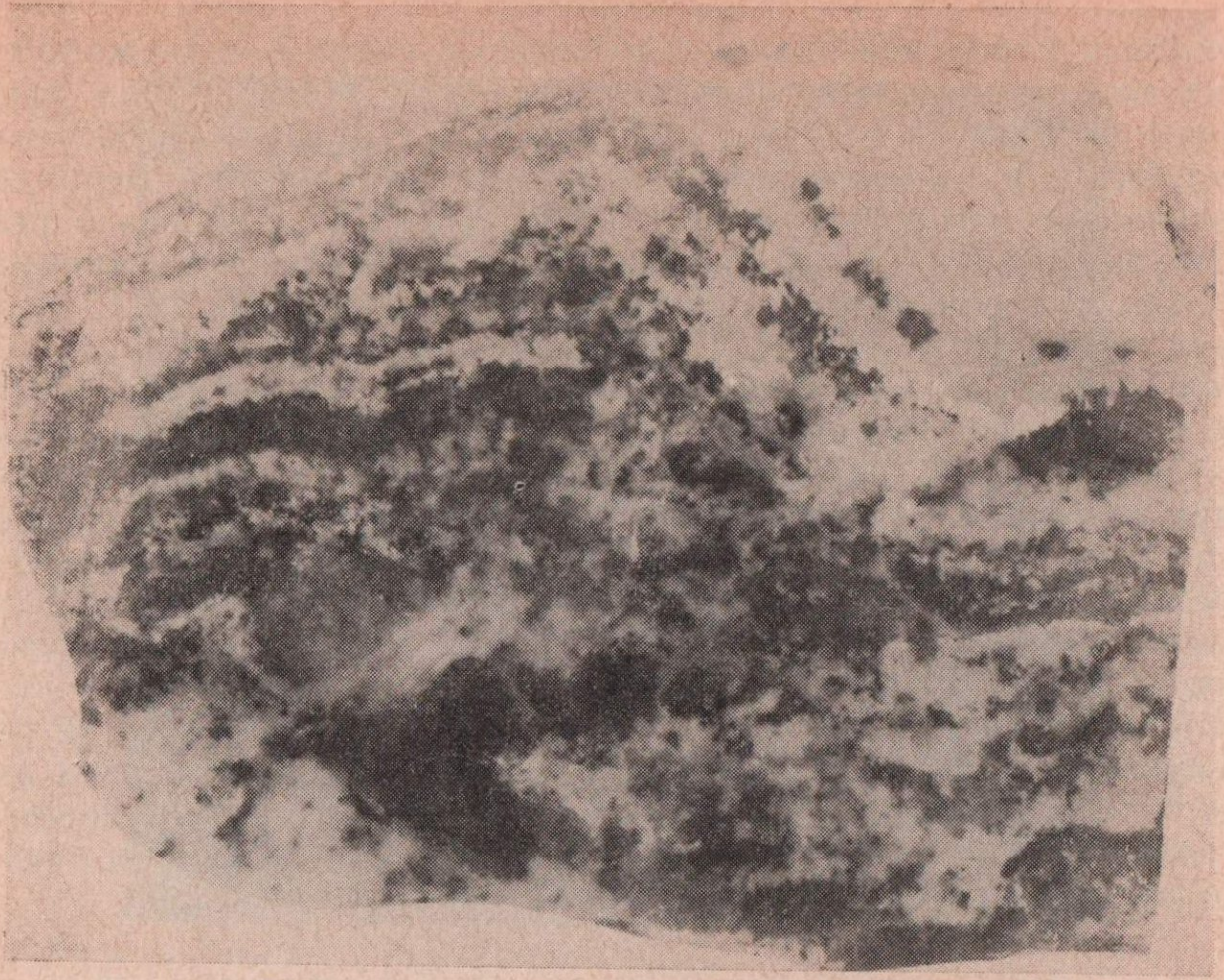
Фиг. 3. Скарн гранат-пироксеновый (с везувианом) полосчатый, интенсивно альбитизированный (белое—мелкозернистый альбит). Natur. вел; Коргеретаба
