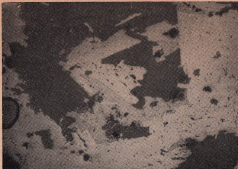
Фиг. 9. Взаимоотношение ильменорутила (серый) с ильменитом (светло-серый). Полир. шлиф. Увел. 250, без анализатора
