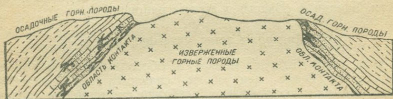
Рис. 46. Схематический разрез области контактов.
