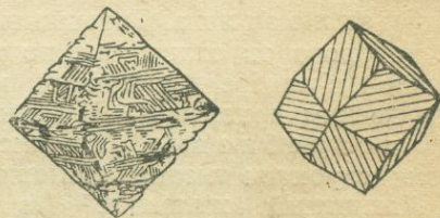
Рис. 66. Формы кристаллов магнетита. (По А. Г. Титову.)
