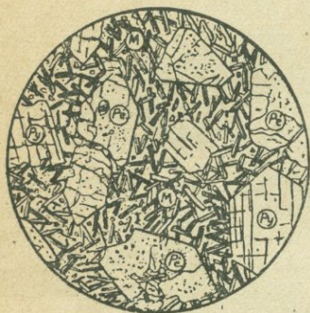
Рис. 110. Базальт под микроскопом. Характерное строение излившейся (вулканической) породы с неполной кристаллизацией. (По Е. В. Милановскому.)
