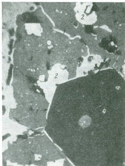
Фиг. 4. Деталь фиг. 2. Пластинчатые, паркетобразные двойники зелигманита при скрещенных николях (торцевой срез игольчатых кристаллов). Увел. 750, в иммерсии
