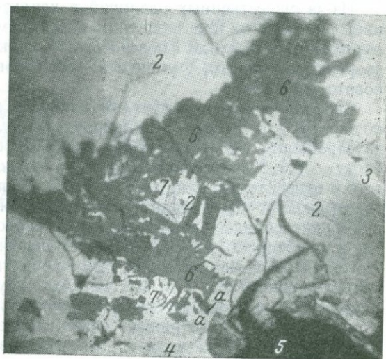
Фиг. 7. Дисперсный сросток теллуридов меди, исследованный микроанализатором JXA-5а. В сростке различимы риккардит (6), вулканит (7) и не полностью замещенные реликты зерен петцита (2). Основная масса шлифа представлена петцитом (2), сильванитом (3), халькопиритом (4), кварцем (5); а—а—направление записи концентрационной кривой теллура. Увел. 750, масляная иммерсия, фильтр зеленый
