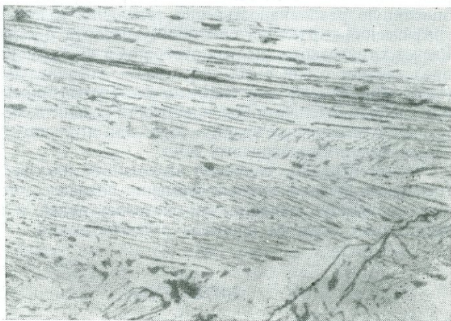
Фиг. 6. Графическая структура срастания козалита (белый) и галенита (серый) протравлено \text{FeCl}_3 , месторождение Караоба, аншлиф. Увел. 150
