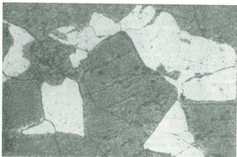
Фиг. 1. Зерна ильменита (белое) в титаномагнетите. Увел. 50, шлиф протравлен, обр. 2191
