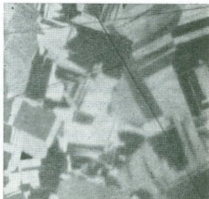
Фиг. 3. Деталь фиг. 2. Фестончатое, ритмично-зональное строение сферолитовых корок синнерита. Увел. 750, в иммерсии
