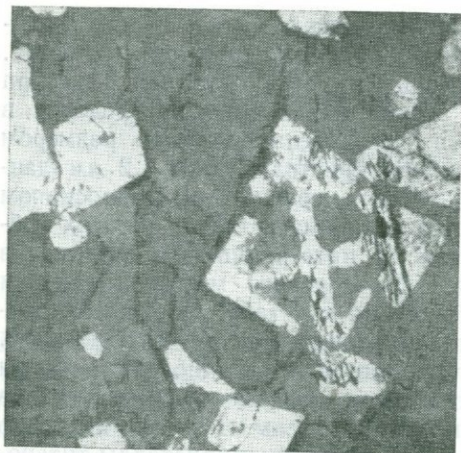
Фиг. 1. Скелетный кристалл титаномагнетита в рудном габбро-диабазе. Увел. 10, полированный шлиф 3555, Пудожгорское месторождение, скв. 370 (глубина 108—109 м)
