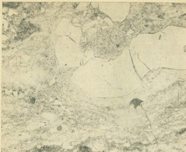
Рис. 1. Игнимбит с дроблеными фенокристаллами плагиоклаза во флюидалной основной массе. Вышково. \times 25 , ник. \perp .
