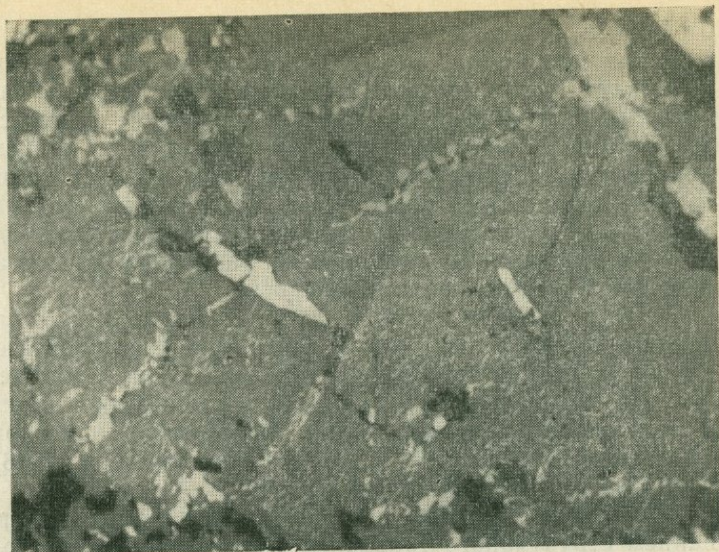
Фиг. 11. Замещение сфалерита (серое) тонкодисперсным халькопиритом (белое) с обособлением более крупных его выделений вдоль трещинок, черное — кварц (полир. шлиф, увел. 100), Катехское месторождение
