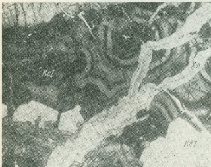
Фиг. 4. Колломорфный касситерит I (Kc I), замещаемый идиоморфными кристаллами кварца I (Kв I) и пересекаемый жилкой позднего хлорита (Хл) (прозрач. шлиф, увел. 20, без анал.)
