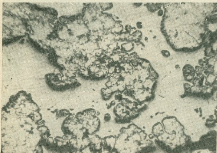
Фиг. 10. Цементация галенитом (белое, гладкое) раздробленных агрегатов пирита (рельефное, светлое); (полир. шлиф, увел. 90), Катехское месторождение
