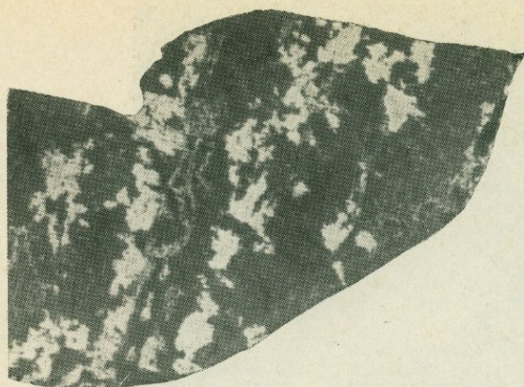
Фиг. 7. Тонкозернистые прожилковидные выделения переотложенного пирита (светло-серое) вблизи обособлений галенита (белое)
