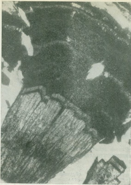
Фиг. 8. Дислокация слоев геля двуокиси олова над неравномерно растущим радиально-лучистым агрегатом касситерита (прозр. шлиф, увел. 90, без анал.)
