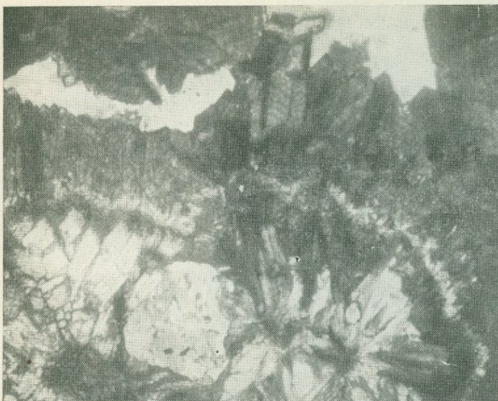
Фиг. 3. «Ельник» из колеччатых двойников касситерита в периферической части метакolloидного агрегата (прозрач. шлиф, увел. 30, николи+)
