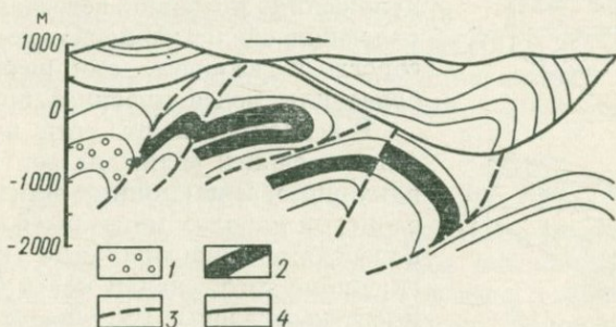
Рис. 89. Чешуйчатые надвиги и шарьяж. Восточные Карпаты. По В. О. Краюшкину и Р. М. Новосилецкому
