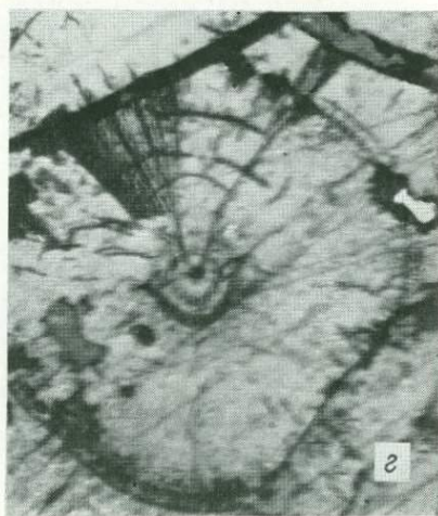
Рис. 30. Центры расщепления сферокристаллов настурана (полированный шлиф, протравленный растворами соды; микрофото Г. А. Дымковой, \times 1000 ).
