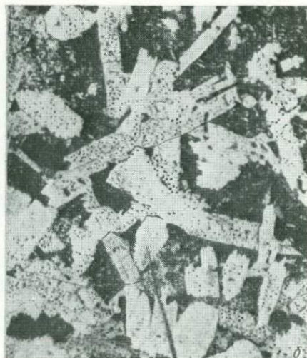
Рис. 27. Продукты прокаливания настурана (образец 9, см. табл. 15):
