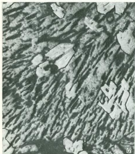
Рис. 27. Продукты прокаливания настурана (образец 9, см. табл. 15):
