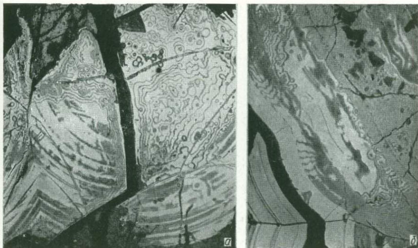
Рис. 67. Ритмичные структуры гидратации и регенерации в гидронастуре Рудных гор (микрофото шлифа, протравленного соляной кислотой; \times 300 ).
