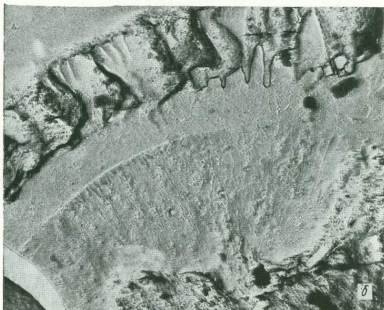
Рис. 61. Растворимая фаза в сферокристаллах настурана; на верхнем снимке сферокристалл обрастается щеткой уранинита (электронные микрофото, \times 12\,000 ).
