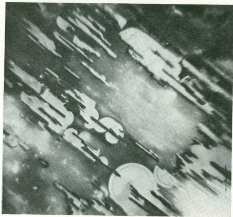
Рис. 50. Сферолиты настурана в полевом шпате (деталь к рис. 4, б). Микрофото шлифа, \times 1000 .
