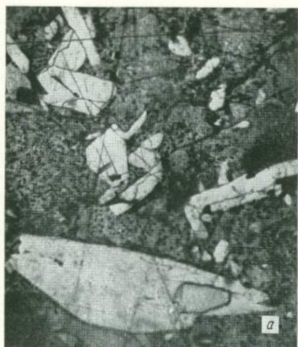
Рис. 22. Спеченная закись-окись с кристаллами U_8O_{21} (а) до восстановления и с трещиноватым сферическим агрегатом UO_2 (б) после восстановления. Микрофото шлифов ( \times 160 ). Участки не совмещены.
