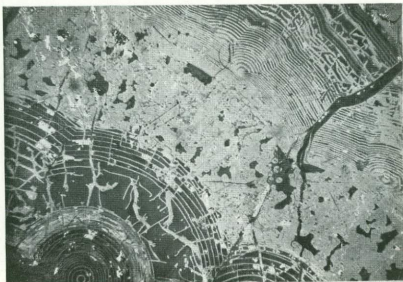
Рис. 75. Зона сферолитовой корки настурана (см. рис. 53, б), выполненная поздним регенерированным настураном [355] ( \times 200 ).
