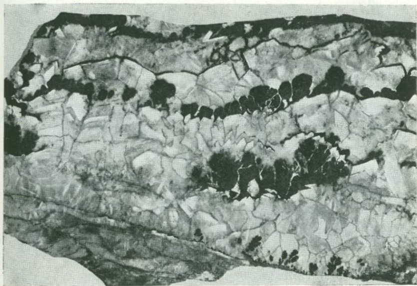
Рис. 5. Полосчатое строение линзы урановой смолки (черное) в кальците (серое). Фото А. Г. Тележки.
