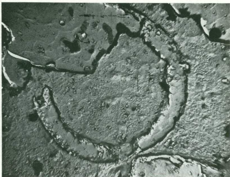
Рис. 72. Кольцевой реликт настурана, замещенный коффицитом (изотропизирован) в массе разложившегося коффицита (электронное микрофото, \times 10\,000 ).
