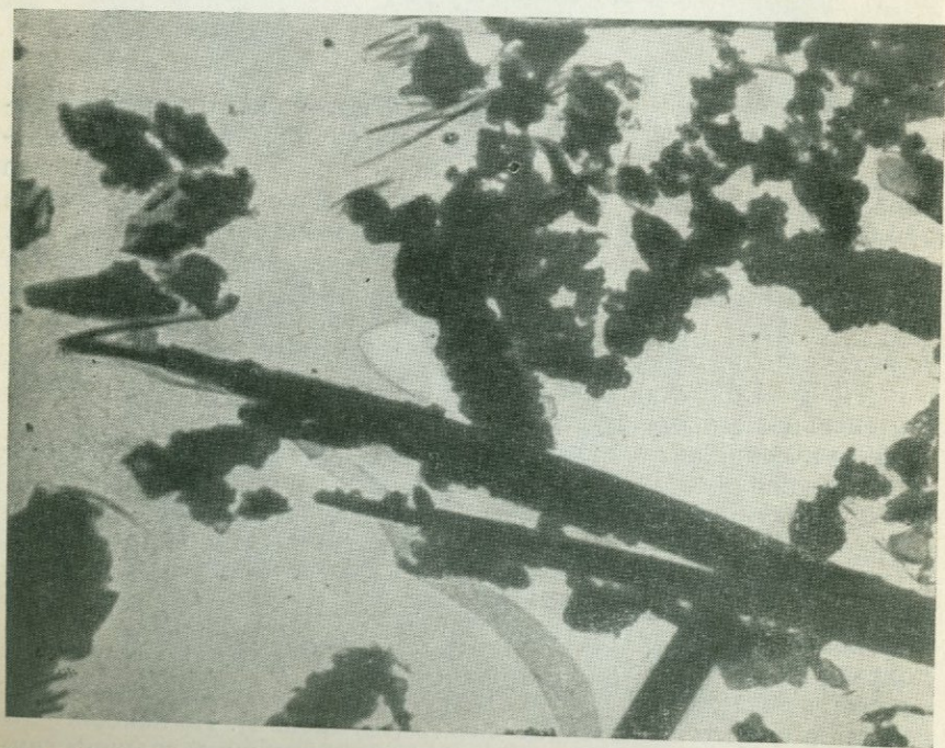
Фиг. 27. Электронная микрофотография синтетического гидральсита. Оп. 194. Увел. 6540
