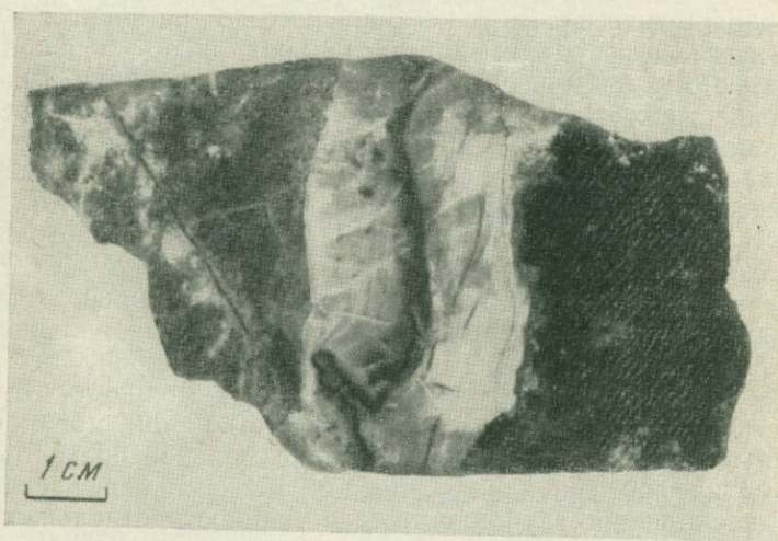
Фиг. 20. Микрizonaльность метасоматических образований а — последовательность зон от центра к периферии: биотитовый гранит (1), гранат-пироксеновый экзоскарн (2), пироксен-шпинелевый скари (3), форстеритовый скари (4) и людвиговая порода (5); б — последовательность зон слева направо: биотитовый гранит, волластонит-гранатовый скари, замещающий шпинель-пироксеновый скари (темная кайма), форстеритовый скари, людвиговая порода с реликтами форстерита, периклаза и карбоната
