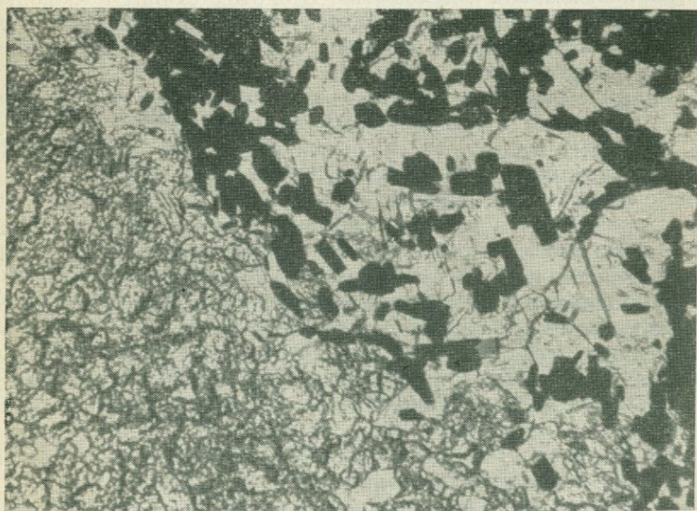
Фиг. 31. Замещение доломитового мрамора (светлое) людвигитом (черное). Форстеритовый скарн (серое) замещению людвигитом не подвергается. Обр. НБ-031
