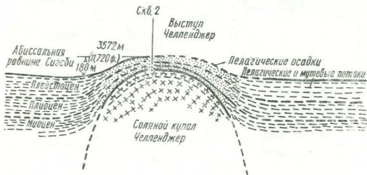
Рис. 52. Схематический разрез выступа Челленджер по данным бурения и сейсморазведки [174]. (Отношение вертикального масштаба к горизонтальному 5 : 1).
