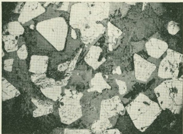
Рис. 17. Зерна титаномagnetита в рудном габбро-диабазе. Пудожгорское месторождение. Полированный шлиф. Увел. 7
